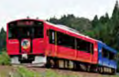
蓄電池電車 (ACCUM) の導入 Introduction of accumulator railcars (ACCUM)
