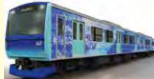
ハイブリッド車両 (燃料電池) 試験車両「HYBARI」の開発 Development of "HYBARI", a hybrid railcar (fuel cell) test car
